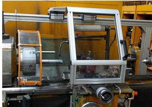
Späneschutz für Drehmaschinen. Verschiebbare Schutzhaube über die gesamte Maschinenlänge.
